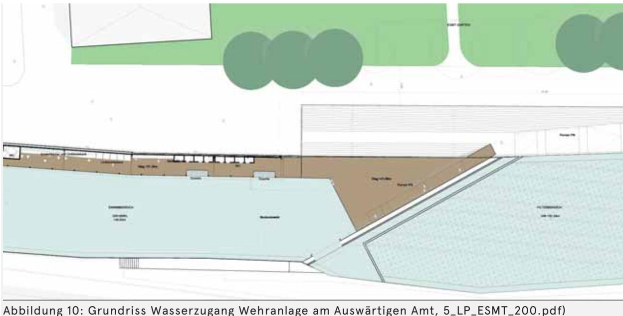
Abbildung 10: Grundriss Wasserzugang Wehranlage am Auswärtigen Amt, 5\_LP\_ESMT\_200.pdf)
