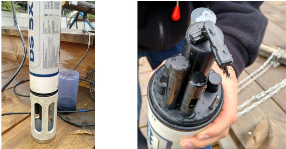
Abbildung 3: Multiparametersonde, Messkopf mit rotierender Bürste zur Reinigung (rechts)
